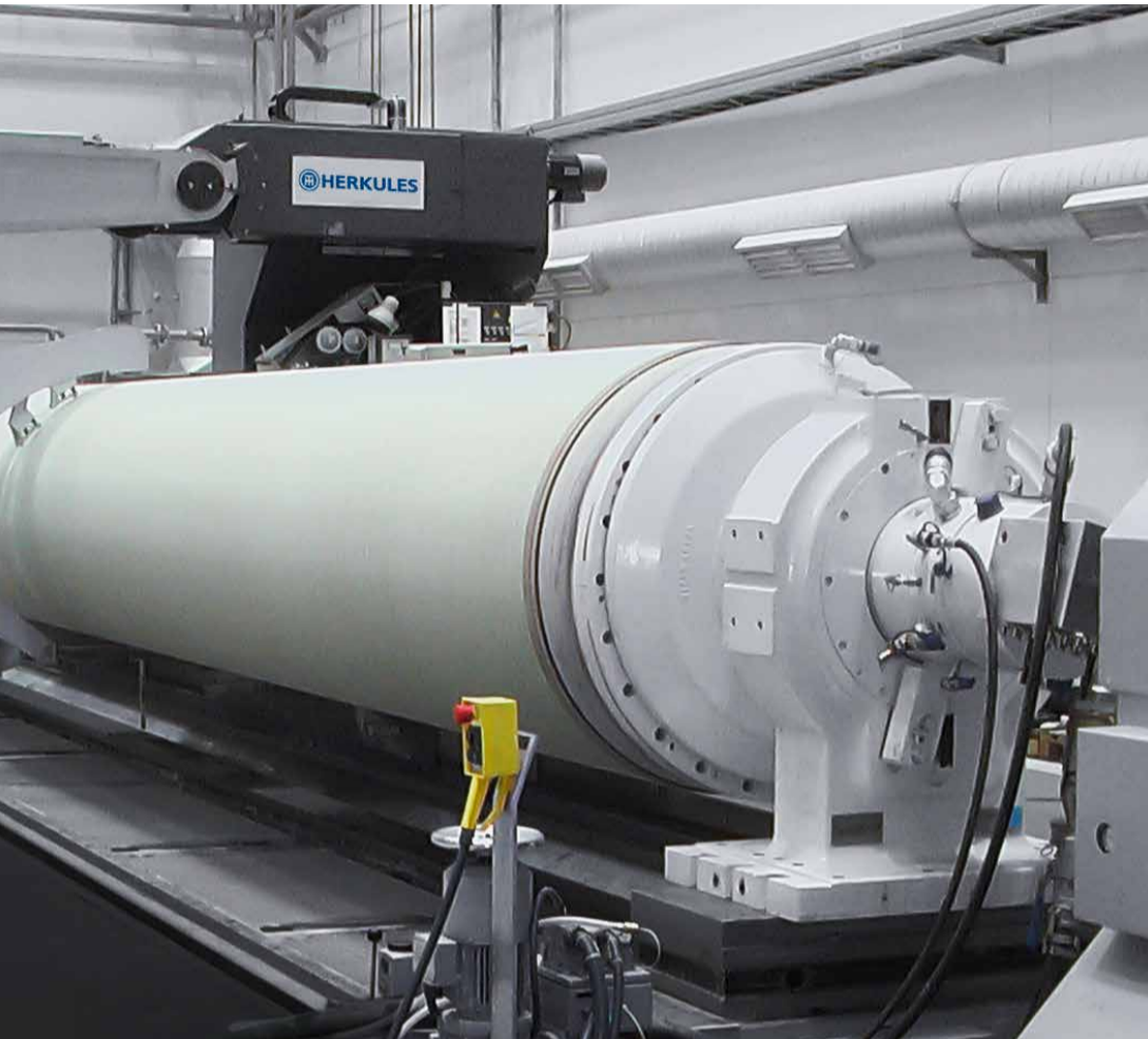
Herkules-Schleifmaschinen bearbeiten Papierwalzen bis zu 17,5 m Länge und 2,5 m Durchmesser
