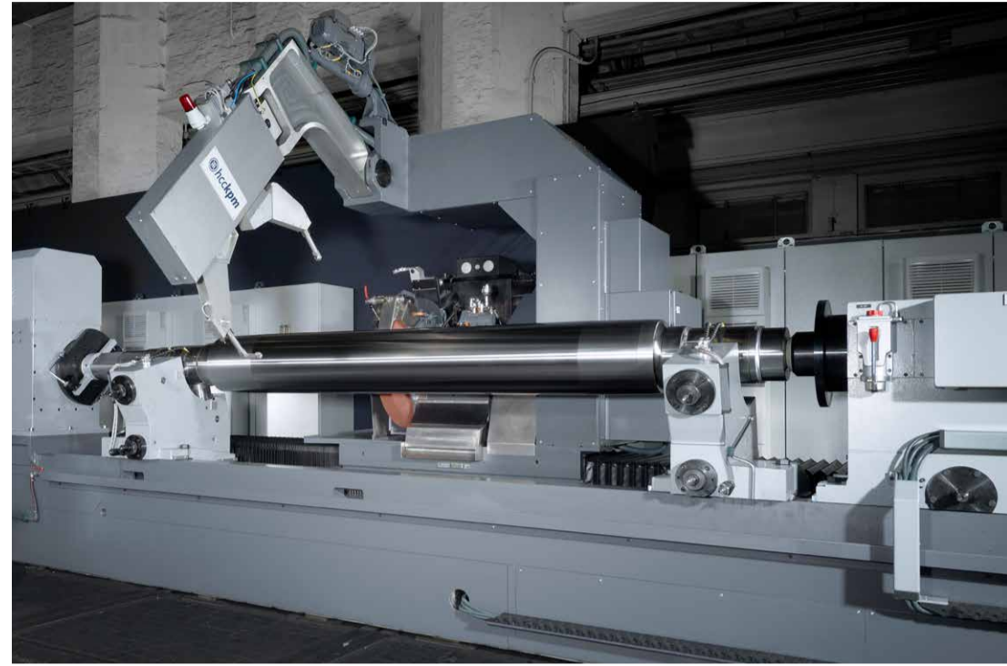
Die fundamentfreie WS 450 ist mit präzisen Messsystemen wie dem C-Frame Caliper ausgestattet
